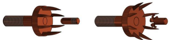
Рис. 12. Ескізи системи катод–анод до вибуху (ліворуч) і після вибуху (праворуч). Катодно-анодна система у складі установки показана на рис. 4.
